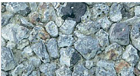
Enduit 6/10 - Simple gravillonnage - PMT = 3 mm
